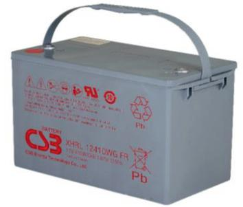
XHRL 12410WG FR - батарея с высокой энергоёмкостью. Особенная кристаллическая решетка электродов позволила увеличить на 20% отдаваемую мощность по сравнению с батареями других серий. Она разработана для эксплуатации в режиме высоких токов разряда при коротком времени разряда. Увеличенный срок службы более 10 лет в буферном режиме (Более 12 лет при 20°C по классификации Eurobat) или более 260 циклов заряда-разряда в циклическом режиме при 100% разряде.
