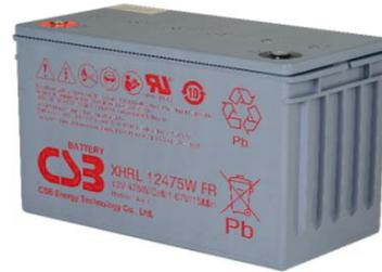
XHRL 12475W FR - батарея с высокой энергоёмкостью. Особенная кристаллическая решетка электродов позволила увеличить на 20% отдаваемую мощность по сравнению с батареями других серий. Она разработана для эксплуатации в режиме высоких токов разряда при коротком времени разряда. Увеличенный срок службы более 10 лет в буферном режиме (Более 12 лет при 20°C по классификации Eurobat) или более 260 циклов заряда-разряда в циклическом режиме при 100% разряде.
